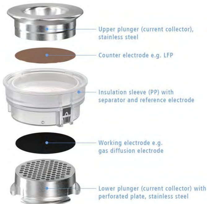
Figure 19 Aufbau einer Batterie in der PAT-Cell
